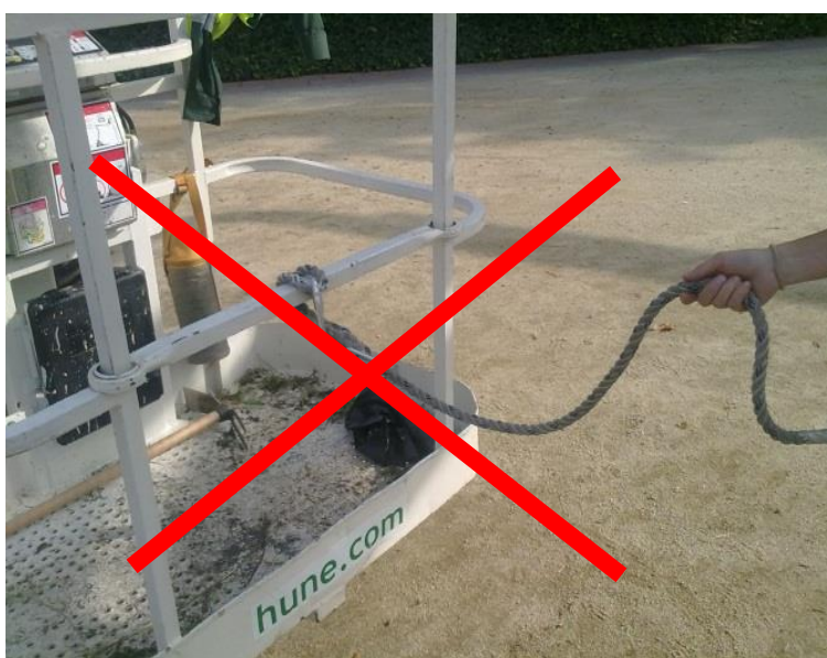
L'eslinga es connectarà sempre a el punt d'ancoratge homologat de la plataforma L'eslinga es connectarà a l'arnes pel punt dorsal.
