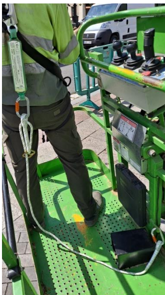
L'eslinga es connectarà sempre a el punt d'ancoratge homologat de la plataforma L'eslinga es connectarà a l'arnes pel punt dorsal.
